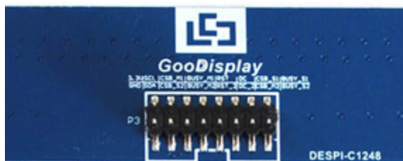
图6 转接板连接器安装位置（排针P3）
