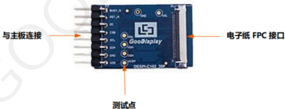
图 2 转接板 DESPI-C1248功能图
