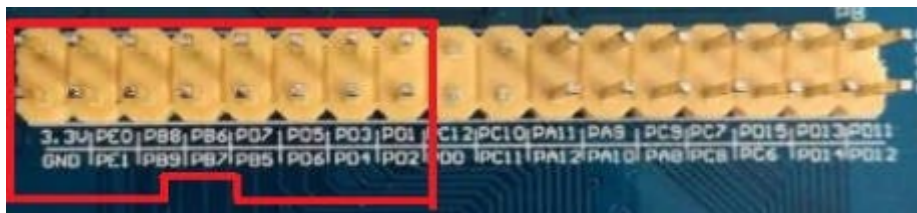
图5 主板连接器安装位置（排针P8）
