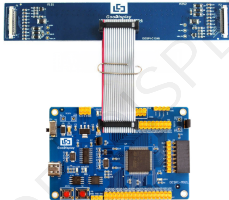
图 3 主板与转接板连接方式
